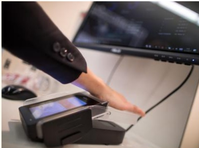
Dieses Gerät erkennt einen bestimmten Menschen am Verlauf der Blutbahnen in der Handfläche. Foto: Daniel Karmann/dpa
