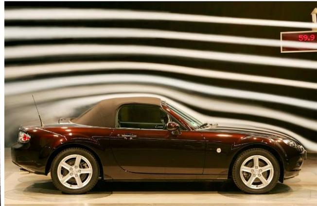
*Abbildung 4.2: Luftströmungen im Windkanal*
