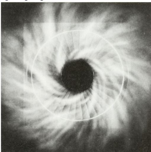
*Abbildung 4.3: Strömungsbild bei einem Drallauslaß einer RLT-Anlage.*
