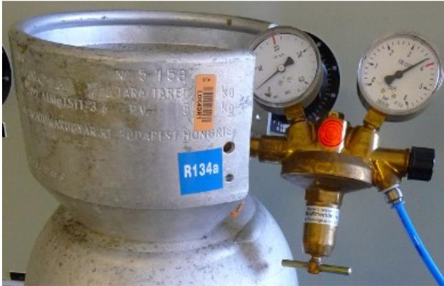
Abbildung 4.1.1: Für die Laborversuche benutztes Flüssiggas; R134a
