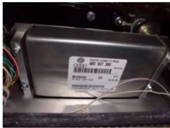
Abbildung 3.2.2 ESP Steuergerät im Lehrstand
