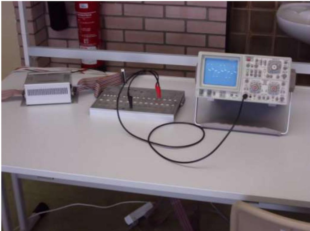
Abbildung 3.7.1 Schülermeßplatz mit Entkoppler und Oszilloskop
